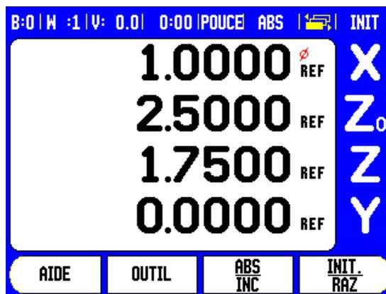
**Activer le couplage des axes Z<sub>0</sub> et Z**
