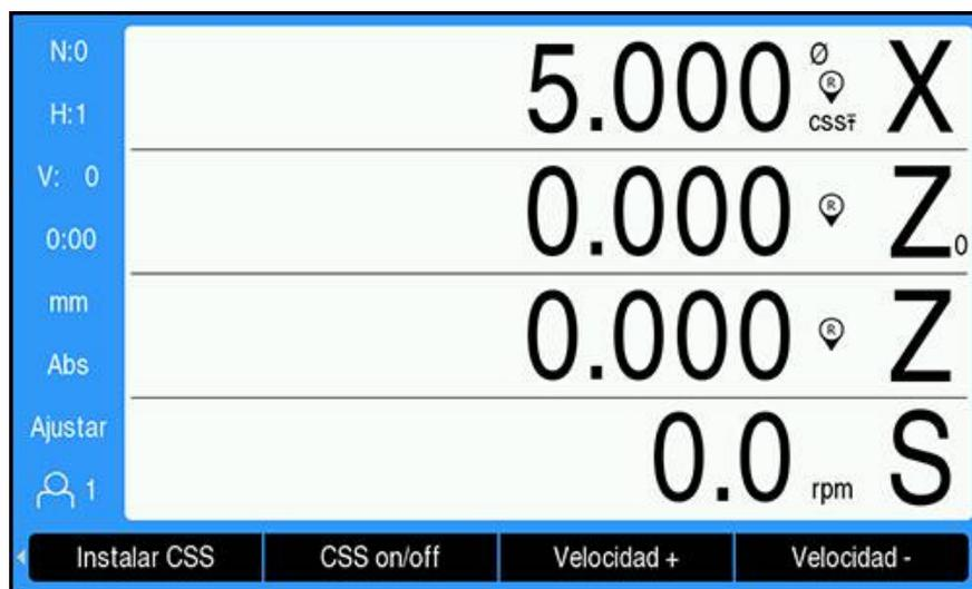
Tras seleccionar el modo de funcionamiento **Funcionamiento** e introducir sus parámetros en el menú **CSS / Directo 1/min** la salida DAC debe ser habilitada para comenzar a controlar el cabezal.
