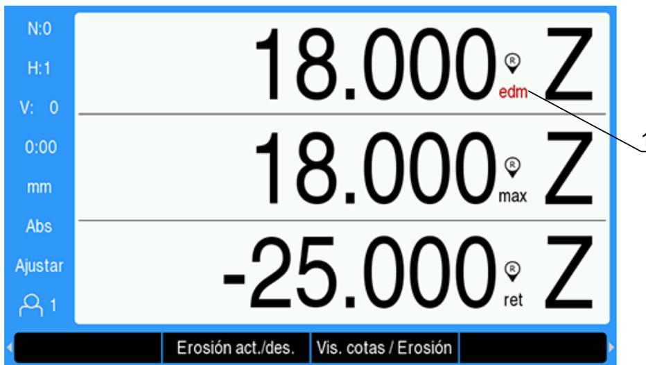
1 Desplazamiento del eje hacia arriba, ciclo de electroerosión no iniciado
