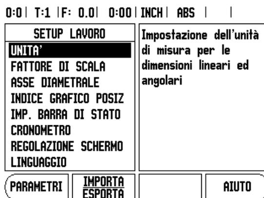
Fig. I.3 La maschera CONFIG. LAVORAZIONE per la fresatura
