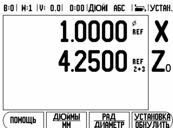
Abb. II.4 Активное сопряжение оси Z
