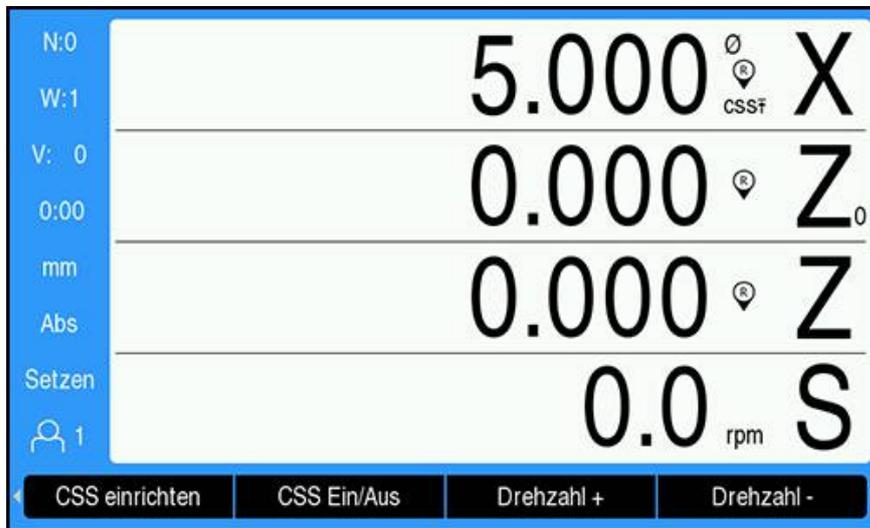
Wenn der **Betriebs**modus angewählt wurde und die entsprechenden Parameter unter **CSS / Direkt 1/min** eingegeben wurden, muss der DAC-Ausgang aktiviert werden, um die Steuerung der Spindel zu starten.
